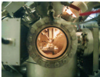
intérieur d'un SIMS, spectromètre de masse utilisé au LAM
